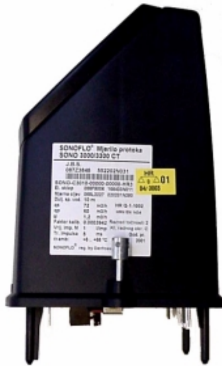
Slika 6: Zaštita kutije s elektroničkim sklopovima mjerila protoka SONOFLO SONO 3000/3300 CT od neovlaštena pristupa
